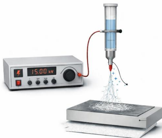
Фиг. 3. Класическа принципна схема на лабораторен апарат за електроовлакняване с вертикална конфигурация
