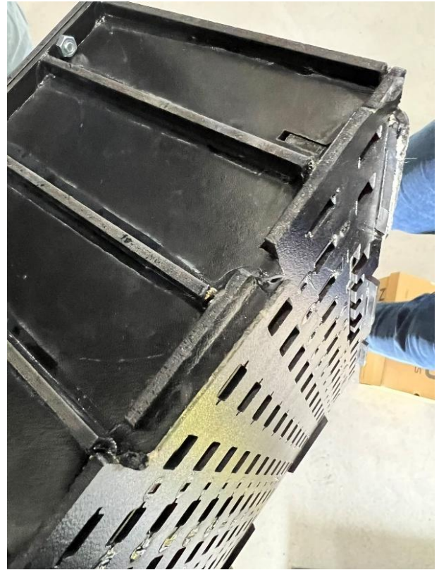
б) Повреди след LC2
