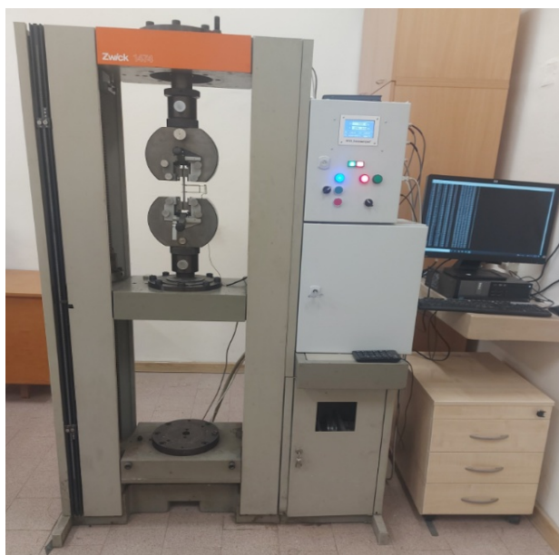
Фигура 57. Снимки на модернизираната система за изпитване на опън.
