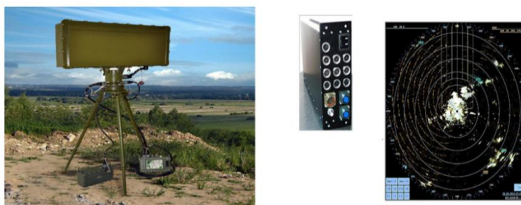
Фиг. 3.31. 3D радар с фазирана антенна решетка, плот-екстрактор и индикатор за кръгов обзор
