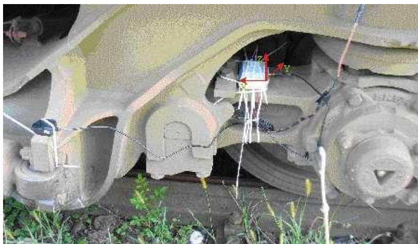
Фиг. 5.12. Измервателно устройство монтирано върху буксов възел
