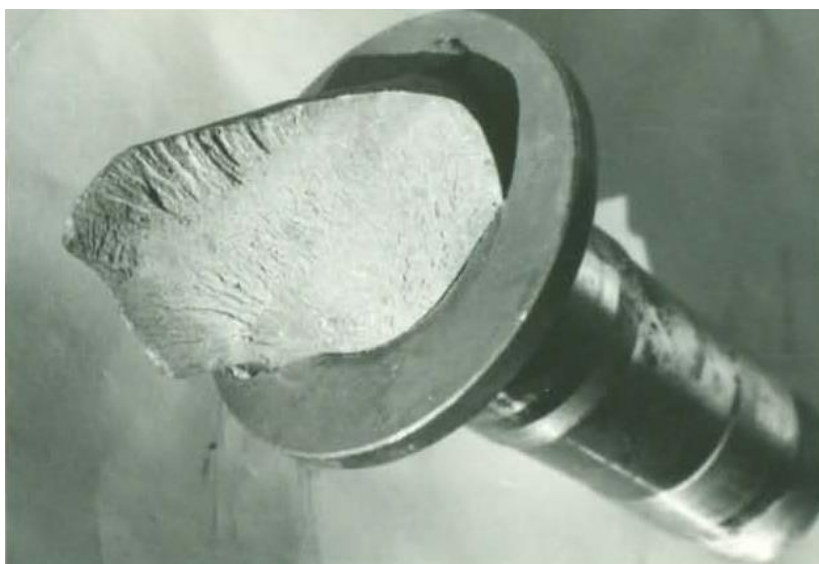
Фиг.1 Разрушеният детайл „колянова ос” от стомана 38ХС
