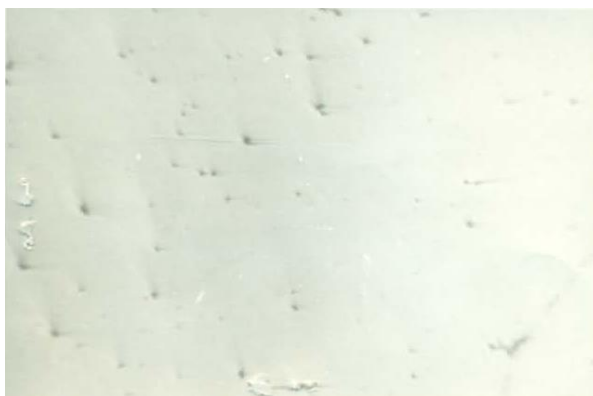
Фиг.2 Неметални включвания, оксиди и сулфиди разположени по оста на детайла от стомана 38ХС.
