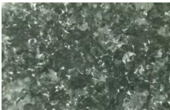
Фиг. 4 Микроструктурата на стомана 38ХС след нормализация е феритно-перлитна с непълна хомогенизация.
