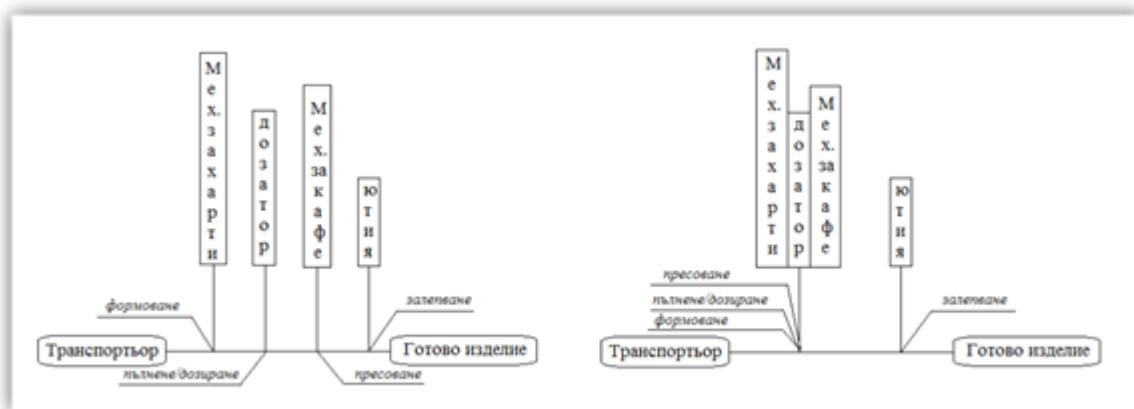
Фиг. 3 Варианти на технологичния процес: в ляво с диференцирани операции, в дясно с концентрирани операции
